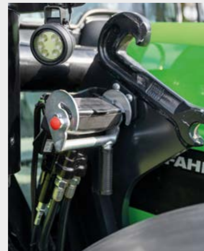
Upínací rám čelného nakladača s Hydro-Fix pripojením hydraulických vedení.
