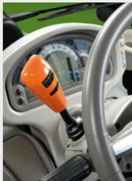
↑ PowerShuttle reverzácia pod zaťažením s nastaviteľnou odozvou.
