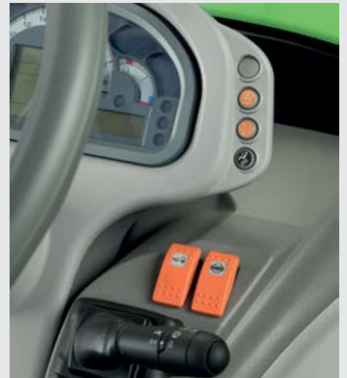
Elektro-hydraulicky ovládaný pohon prednej nápravy a uzávierky diferenciálu.
