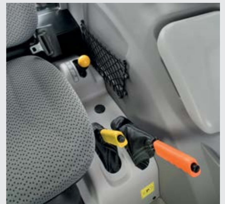
Až tri rýchlosti otáčok vývodového hriadeľa, ktoré možno zvoliť pomocou mechanickej páky.
