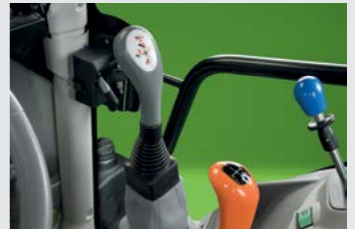
Plne integrovaný joystick predného nakladača.
