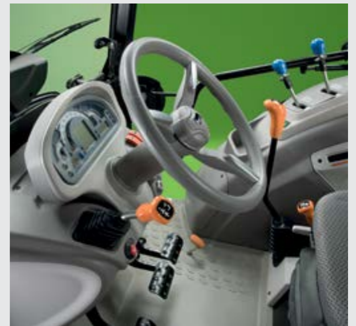
5-rýchlostná prevodovka s mechanickou reverzáciou pojazdu na prístrojovej doske.
