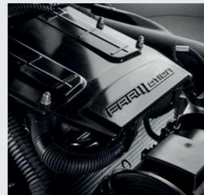
↑ Motor FARMotion 35 so vstrekovaním Common Rail a výkonom až do 102 koní, ktorý splňa najnovšie emisné normy Stage V.
