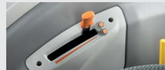
↑ Elektronický ručný plyn s dvomi pamätami otáčok.
