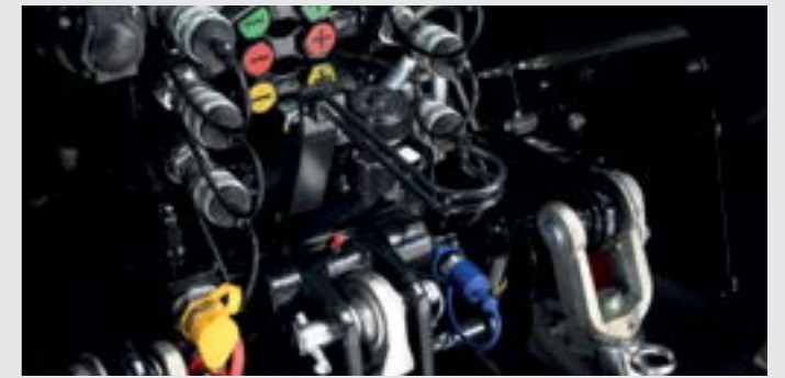
Až tri zadné hydraulické okruhy s reguláciou prietoku a spätnou klapkou hydraulický olej.
